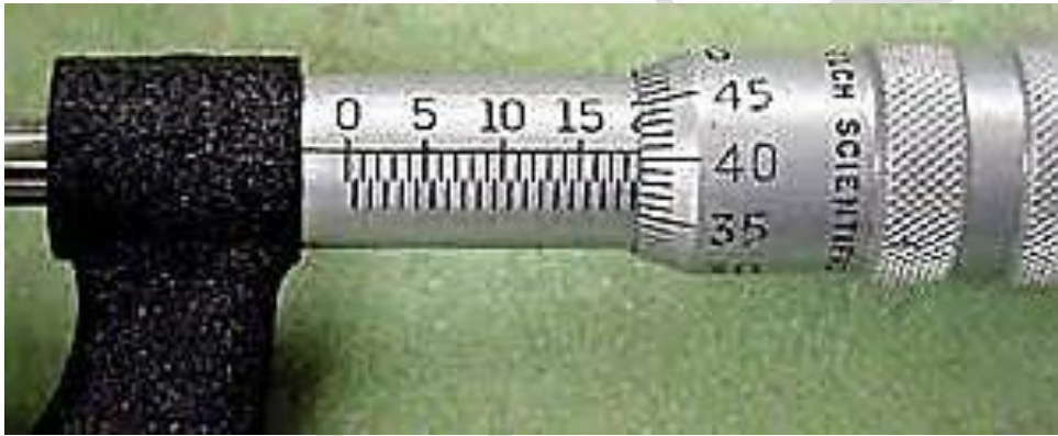
الشكل (5): آلية قراءة الأبعاد باستخدام الدوارة اللولبية.
